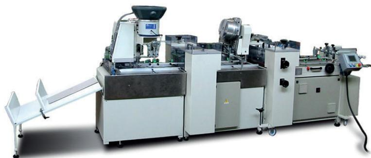
Linea automatica componibile per cordonare planche di cartone, fissare un occhiello dito e due occhielli rado. In versione semplificata. (CORD-R + DT15 + RADO15)
